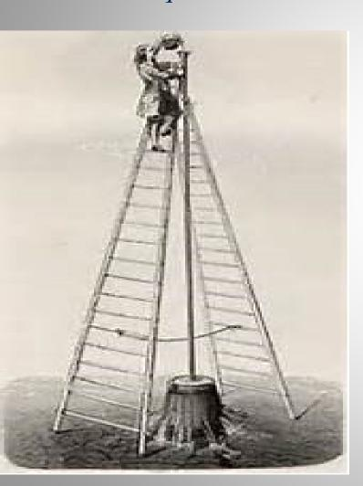
A= 3,14 x  $r^2$  = 3,14 x 0,50<sup>2</sup> = 0,78 m<sup>2</sup> Fi=PixhxA= $\varphi$ .h.A= $\rho$ .g.h.A=1.000 [kg/m<sup>3</sup>] x 9,81 [m/s<sup>2</sup>] x 10,33 [m] x 0,78 [m<sup>2</sup>]=79.043 [N] = 7.904 daN
