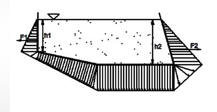
Premesso che la massa Volumica (Densità)  $\rho = 1.000 \text{ kg/m}^3$  e il Peso Volumico  $\phi = \text{mg/V}$  (Peso/Volume [kg.m/s²/m³=N/m³]) espresso meglio come  $\phi = \rho$ .g cioè 1.000 [kg/m³] x 9,81 [m/s²] = 9.810 [N/m³]. (N.B. 1 daN=10N che è un kg).
